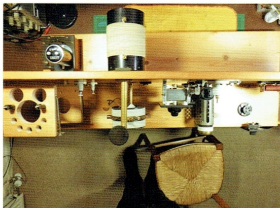
• Afbeelding 9. Anodecondensator, ontkoppelcondensator en anodespoel aangebracht.
