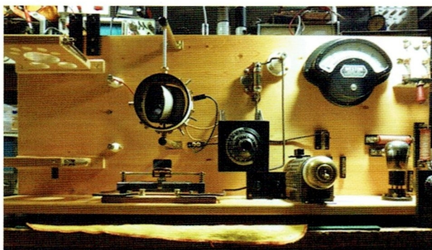
• Afbeelding 10. De tweede regelweerstand en een gedeelte van de gloeidraadaansluiting zijn klaar.
