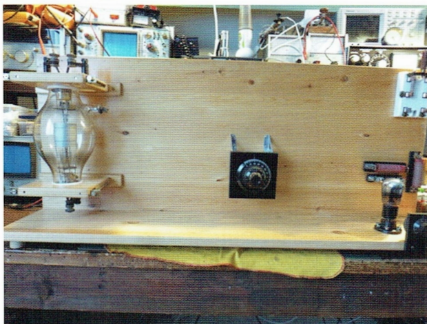
• Afbeelding 5: Bevestiging van de lamphouder.
